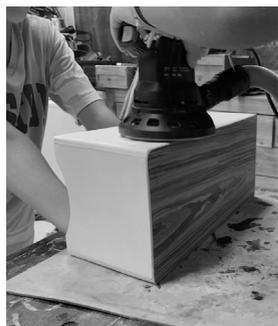
Die BongoCajón ist eine Holztrommel, die üblicherweise fast immer in Verbindung mit kuhfellbespannten Congas gespielt wird. Die recht aufwändige Mechanik besteht aus mehreren hölzernen Kleinteilen und einem zerteilten Snareteppich, der erst das typische Schnarrgeräusch der BongoCajón erzeugt. Nachdem das Innenleben der BongoCajón montiert ist, werden die Sperrholzfelde furniert und verleimt. Die gesamte Trommel wird geschliffen, angefasst und abschließend mit Öl, Wachs oder Klarlack veredelt.
