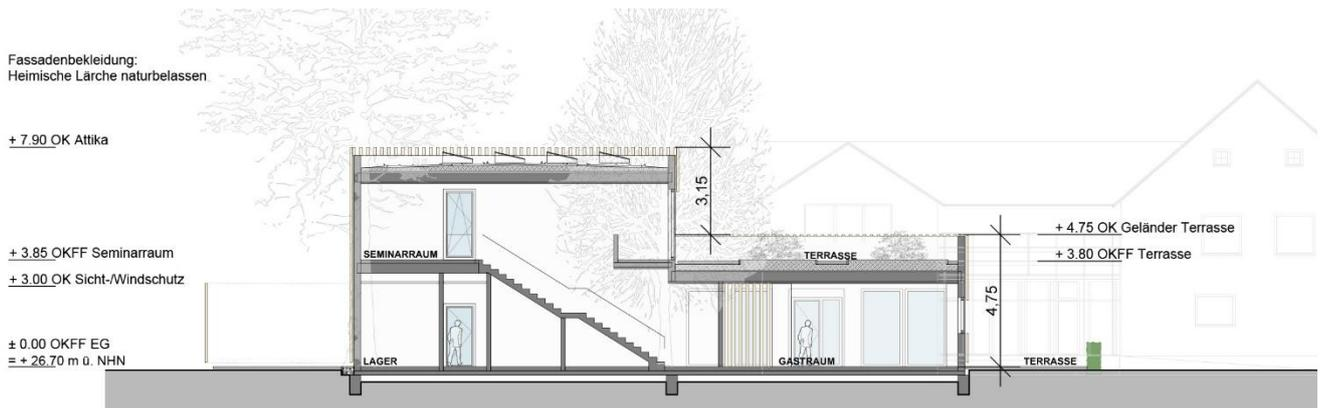
Abbildung 13: Bauliches Konzept, Neubau Hof „Emschermündung“ – Schnitt A-A (ohne Maßstab)
