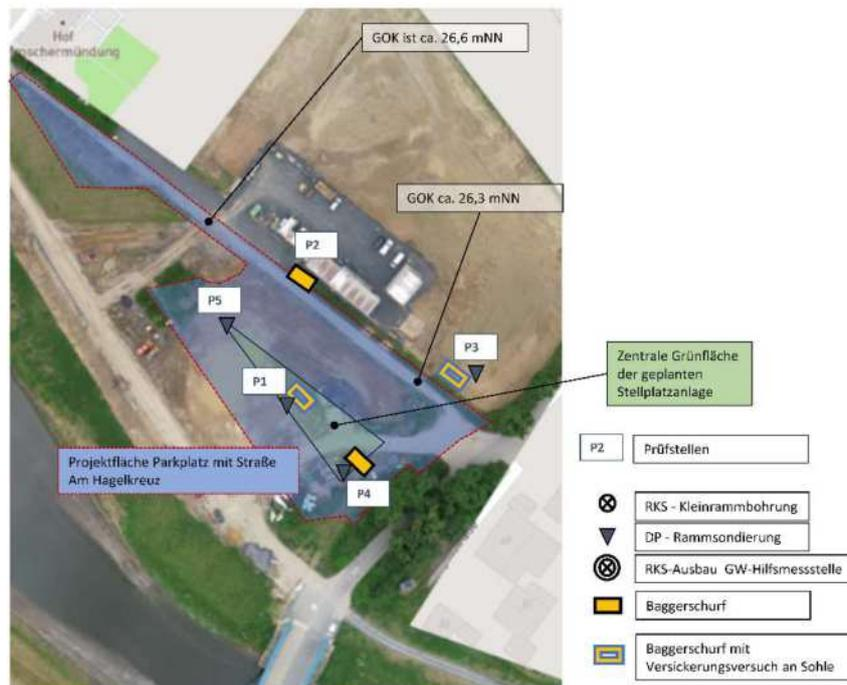
Abbildung 3: Ergänzendes Erkundungskonzept zur Versickerungsuntersuchung für den Bereich VBB Stellplatz gemäß /2.10/
