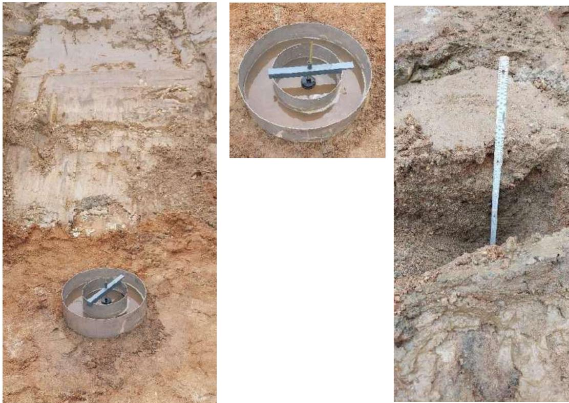
Abbildung 7: Versickerungsversuch mit Sohlaufgrabung in Schurf P3 (östlich Hagelkreuz) am 07.05.2024
