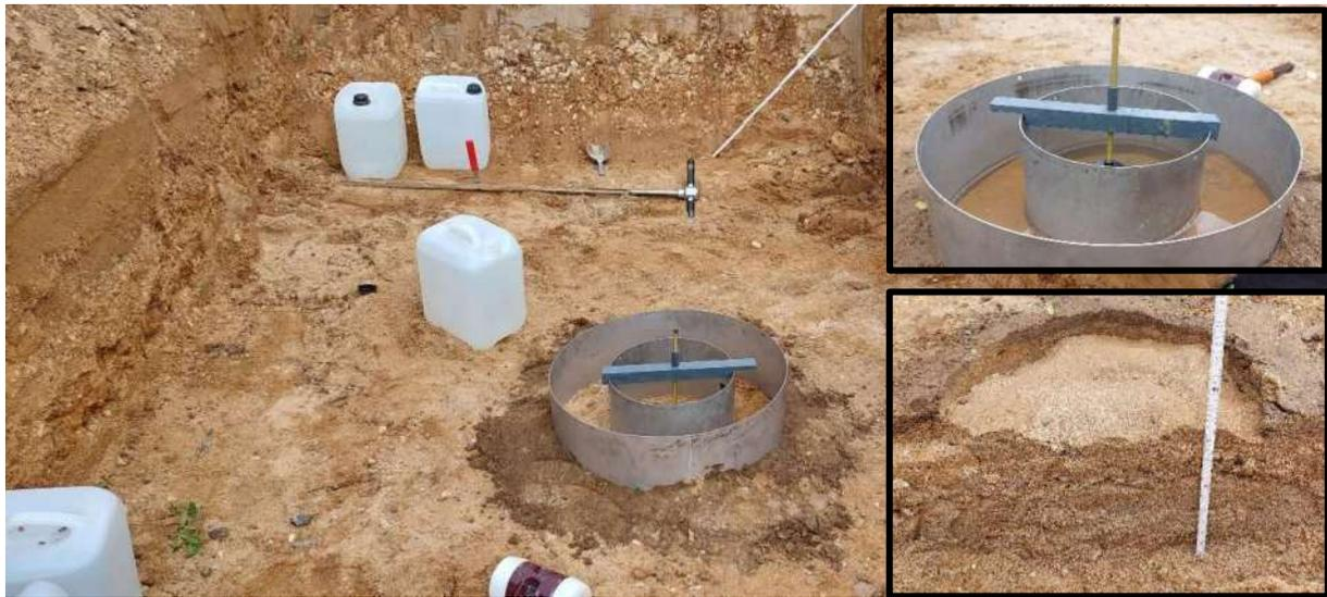
Abbildung 6: Versickerungsversuch mit Sohlaufgrabung in Schurf P1 am 05.07.2024
